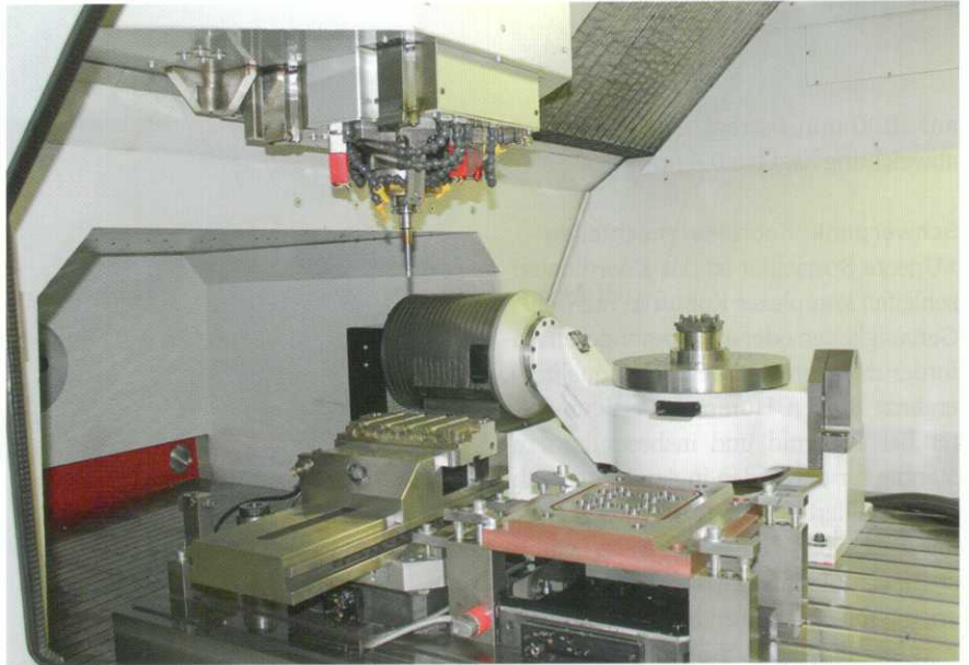
4 Arbeitsraum der RXU 1200: im Hintergrund der aufgesetzte Dreh-Schwenktisch; Besonderheit ist die sehr steife, an allen vier Ecken geführte Quadroguide-Z-Achse (© Vollrath)
