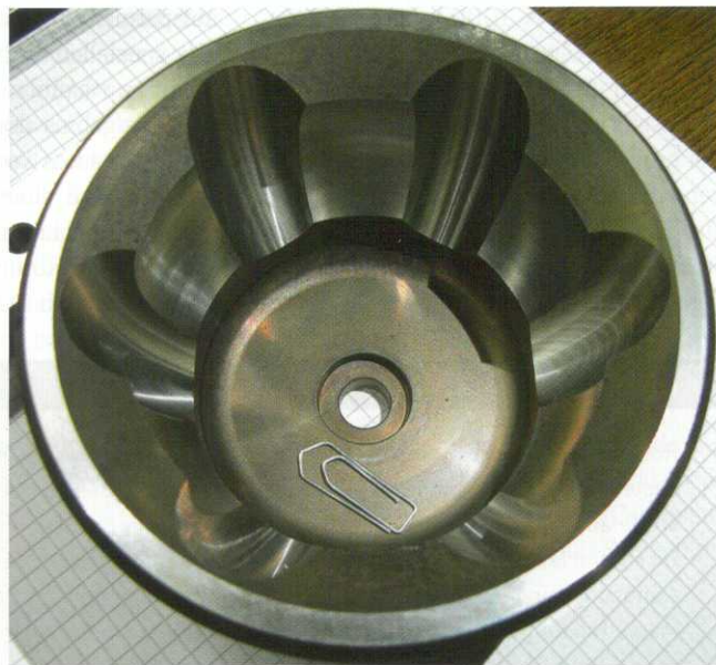
3 Schräghubgeschliffener Formeinsatz mit 56 HRC und 2,5\text{ }\mu\text{m} Toleranz der konischen Passflächen (links); fünfachsig HSC-gefräster Einstellmeister für ein Kfz-Achsbauteil mit 60 HRC und kleiner 5\text{ }\mu\text{m} Form- und Lagetoleranzen sowie Koaxialität (rechts) (© TSchmid (links), Vollrath (rechts))
